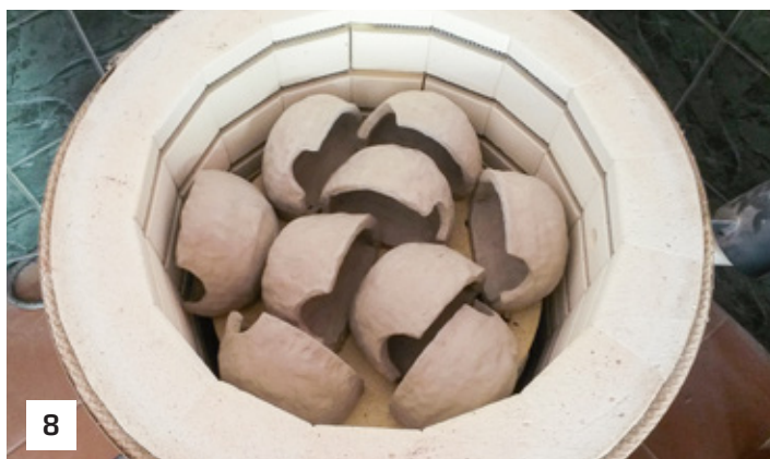
Připravená hnízda necháme zvolna vyschnout dnem vzhůru, aby nepopraskala. Po vyschnutí je vypálíme v keramické peci, stačí na přezah.
